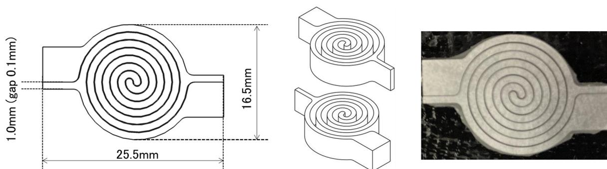
電極幅を1mmとした渦巻形状における回転方向の動きを抑制するためのフランジ構造を有し電極間距離を0.1mmとしています。この形状により、取り付け角度の方向依存性がなくなり、また、腐食挙動を平均的に捉えられます。電極間の隙間にはエポキシ樹脂を充填し、事前に金属の表面処理を行うことによって、すき間腐食の発生を抑制しています。
